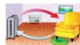
هوای بالای رادیاتور گرم می‌شود و انساط پیدا می‌کند و چگالی آن کم می‌شود؛ در نتیجه به طرف بالا حرکت می‌کند و هوای سرد بالا و اطراف که چگالی آنها بیشتر است، به طرف پایین حرکت می‌کند و به رادیاتور نزدیک می‌شود. این هوای سرد نزدیک شده نیز گرم و منبسط می‌شود و چگالی آن کم می‌شود و به طرف بالا حرکت می‌کند. بدین ترتیب گردش هوای در خانه اتفاق می‌افتد و هوای قسمت‌های دور از رادیاتور نیز گرم می‌شود.
