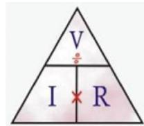
۷۰- مثال: دو سر یک لامپ رشته‌ای به ولتاژ ۲۲۰ ولت وصل است اگر مقاومت لامپ ۴۸۴ اهم باشد چند آمپر جریان الکتریکی از لامپ می‌گذرد.
