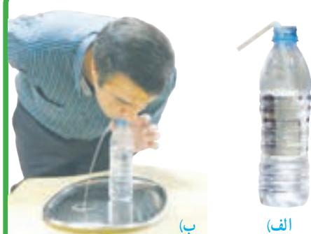
یک نی را مطابق شکل (الف) داخل یک بطری محتوی آب قرار دهید. درحالی که نی درون بطری قرار دارد مطابق شکل (ب) دهانه بطری را بالب های خود به طور کامل بگیرید و درون بطری بدمید. آنچه را مشاهده می کنید، با توجه به آثار فشار هوا و همچنین اصل پاسکال توضیح دهید.
