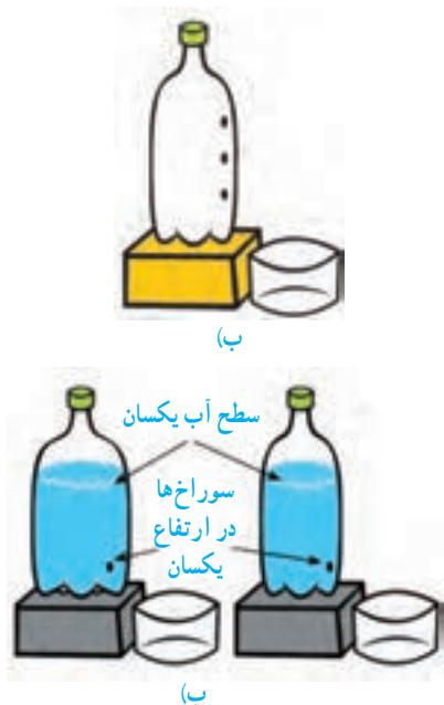
۵- مطابق شکل (پ) آزمایش را با دو بطری  $1/5$  و  $2$  لیتری انجام دهید. توجه کنید که سوراخ‌ها را به طور مشابه و در ارتفاع یکسان روی هر دو بطری ایجاد کنید. همچنین سطح آب در هر دو بطری مساوی باشد.
