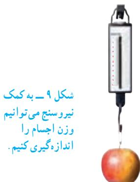
شکل ۹— به کمک نیروسنج می‌توانیم وزن اجسام را اندازه‌گیری کنیم.
