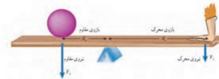
شکل ۱۱ – شکل اهرم که در آن بازوی محرك، نیروی مقاوم و نیروی مقاوم نشان داده شده است.
