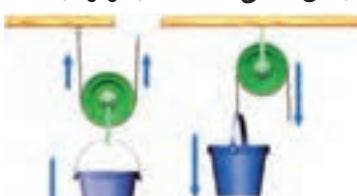
شکل ۱۲- قرقره ثابت و قرقره متحرک
